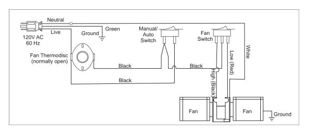
Blower / Fan Wiring Diagram
